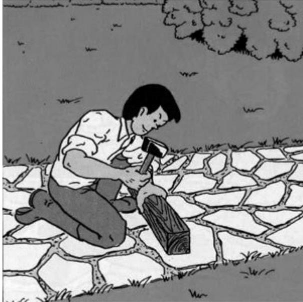
Bloquez les dallages de niveau à l'aide d'une règle en bois et d'un marteau. Respectez la pente pour l'écoulement de l'eau.
