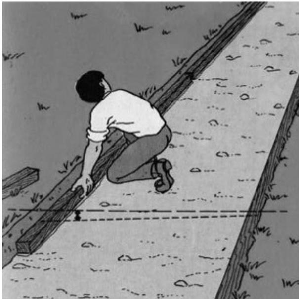
Scellez au mortier des chevrons sur les bords de l'allée ; ils seront réglés à la hauteur exacte de la dalle de béton, en tenant compte de la pente.
