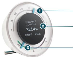
1 L'aiguille indique en temps réel la puissance consommée en Watts.
