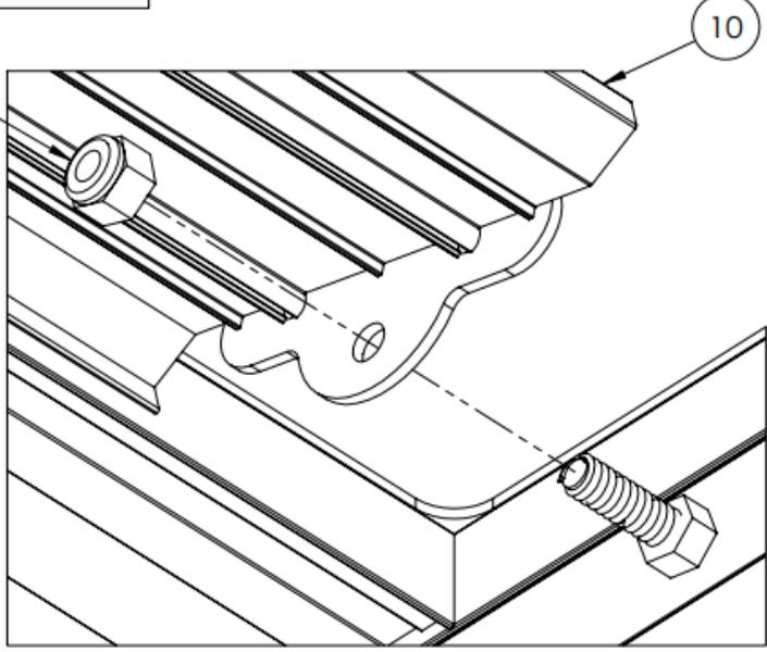
Attention : veiller à serrer modérément les écrous afin de ne pas entraver le bon fonctionnement du mécanisme
