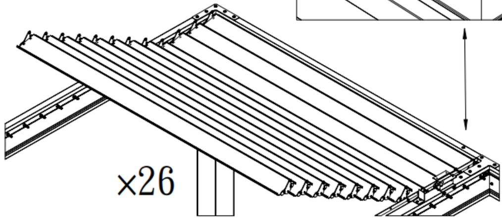
**Attention : veiller à serrer modérément les écrous afin de ne pas entraver le bon fonctionnement du mécanisme**
