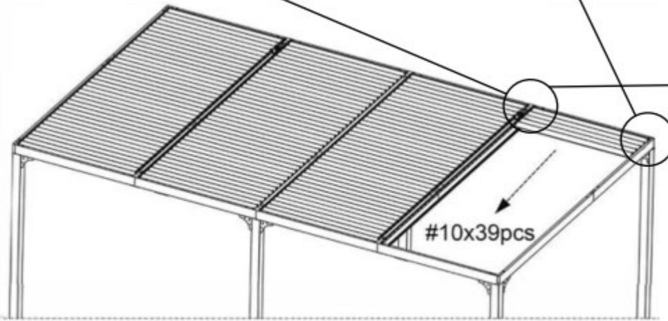
**ATTENTION : veiller à serrer modérément les écrous afin de ne pas entraver le bon fonctionnement du mécanisme.**
