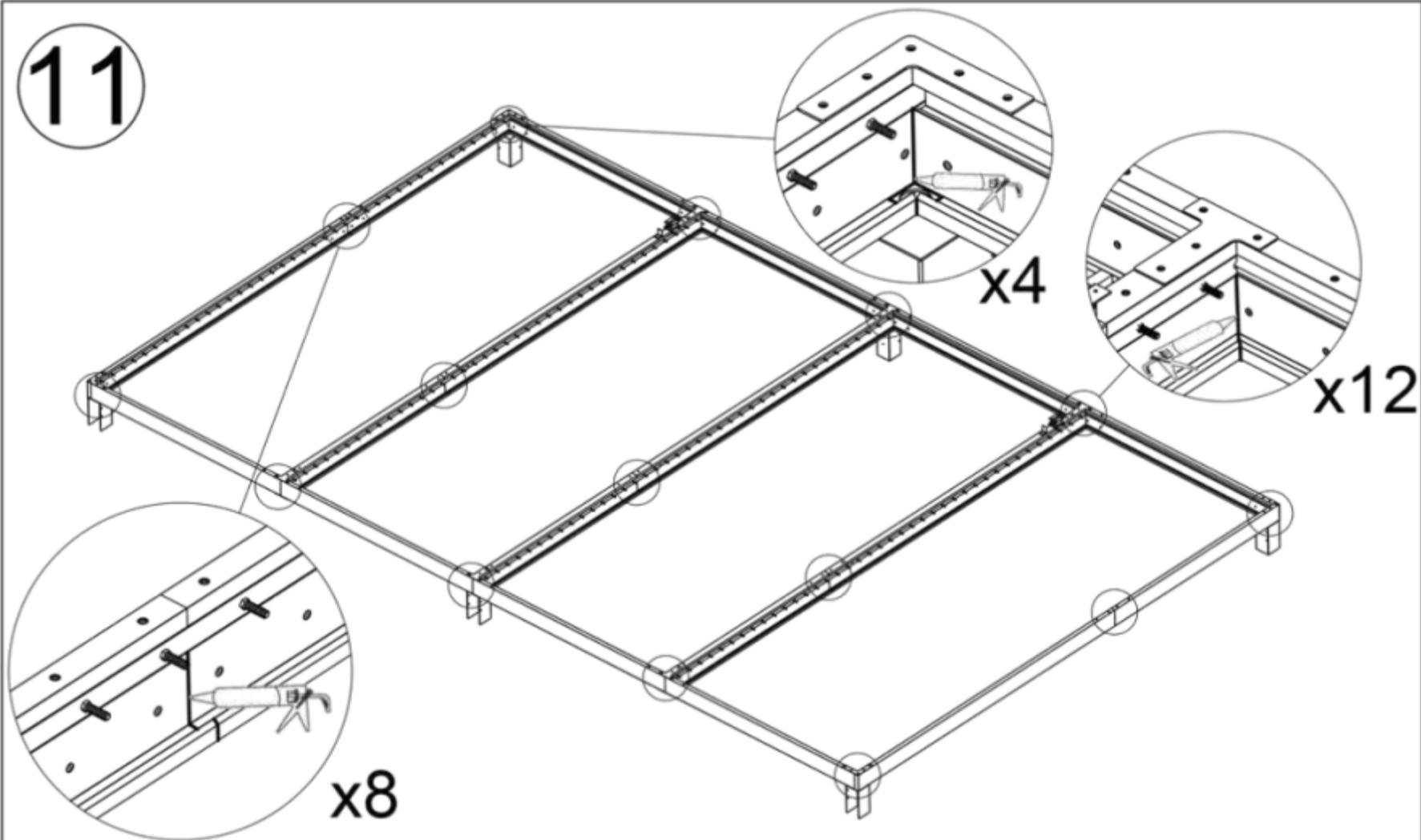
Pour maximiser l'étanchéité des gouttières, appliquer un mastic d'étanchéité d'extérieur (non fourni) à toutes les pièces en contact.
