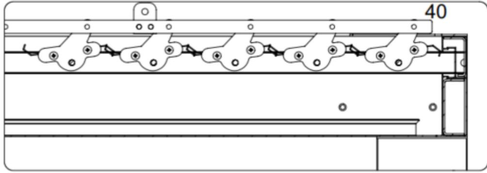
**ATTENTION : veiller à serrer modérément les écrous afin de ne pas entraver le bon fonctionnement du mécanisme.**
