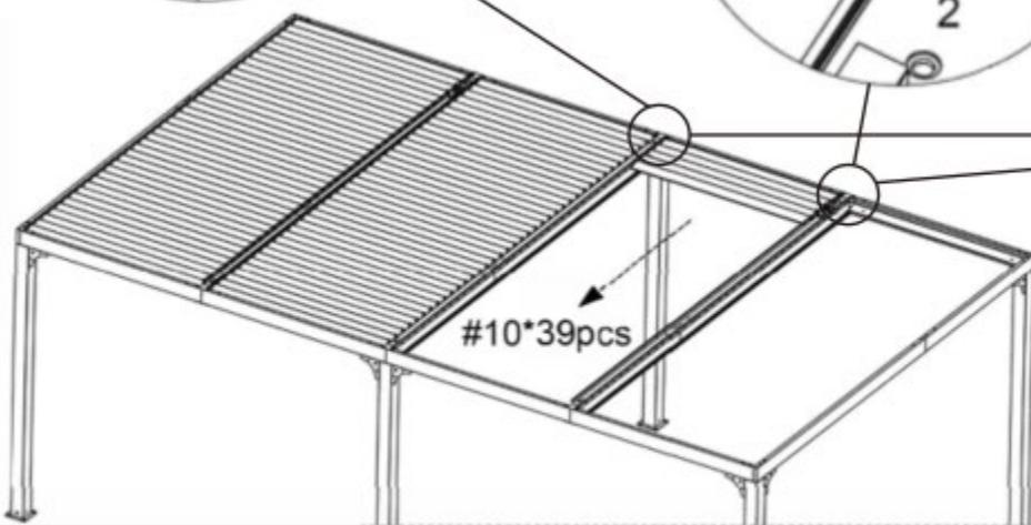
**ATTENTION : veiller à serrer modérément les écrous afin de ne pas entraver le bon fonctionnement du mécanisme.**
