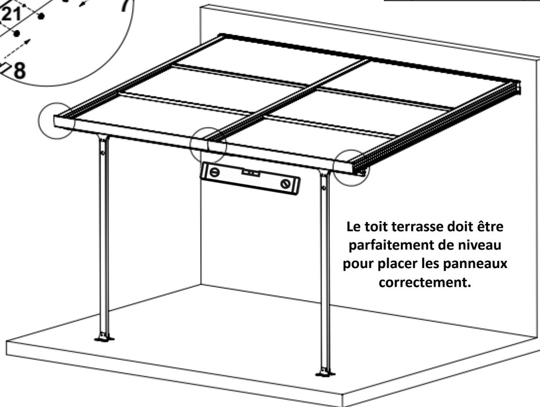
Le toit terrasse doit être parfaitement de niveau pour placer les panneaux correctement.
