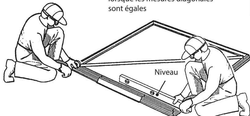
Le cadre de plancher doit impérativement être d'équerre et de niveau, faute de quoi les trous ne seront pas alignés.
