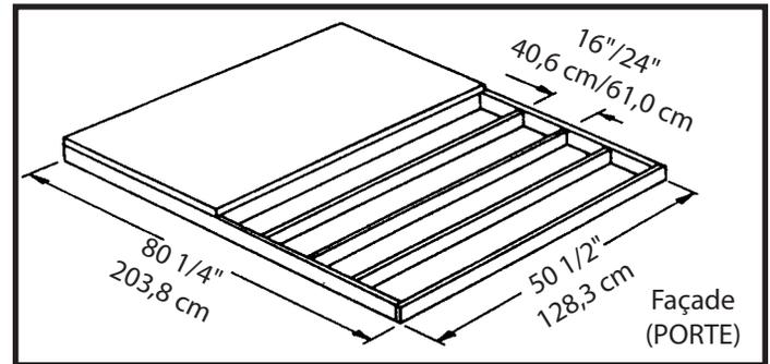
**Note :** La plate-forme ou la dalle dépassera de 1,4 cm (9/16") le cadre de plancher sur les quatre côtés. Pour une plate-forme en bois, scellez ce surplomb de 1,4 cm (9/16") avec du ciment pour toiture (non fourni). Pour une dalle en béton, biseaux ce surplomb de 1,4 cm (9/16") quand vous coulez le béton. Vous assurerez ainsi un bon écoulement des eaux.
