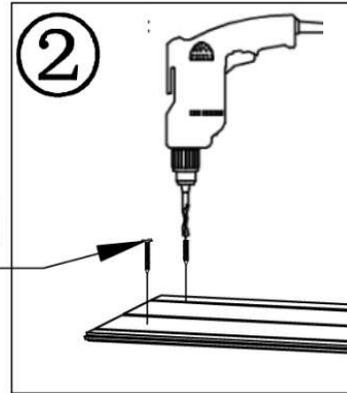
Puis visser dans les trous pré-établis sans bouger la lame. Attention à bien régler la puissance, et ne pas trop forcer, risque de transpercer
