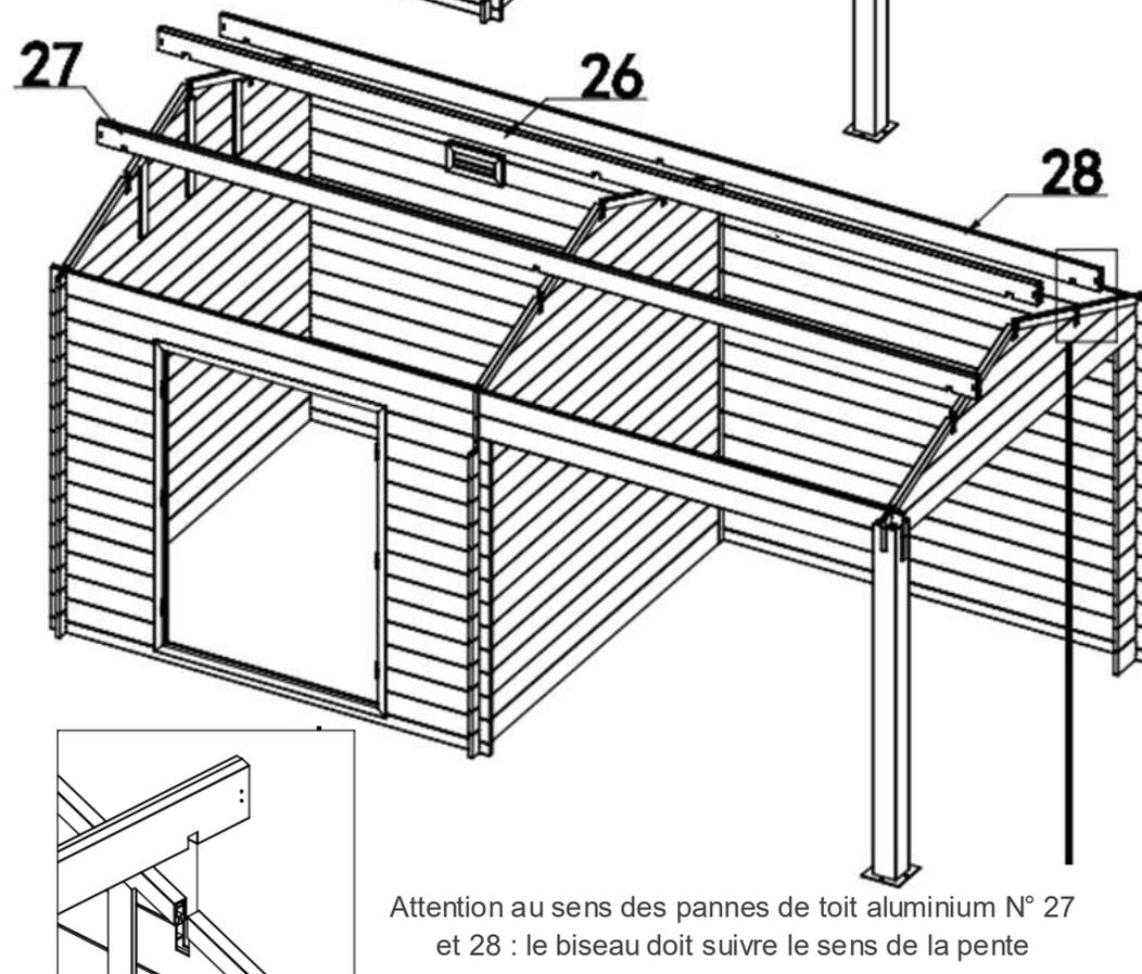
Attention au sens des pannes de toit aluminium N° 27 et 28 : le biseau doit suivre le sens de la pente
