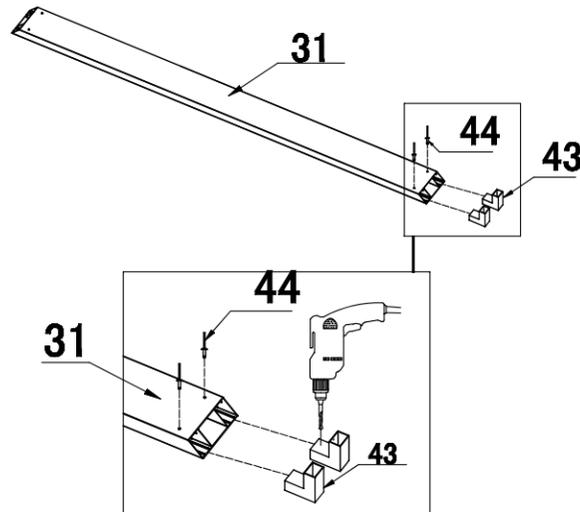
Placer les coin de renfort dans la panne de toit, et percer au bon emplacement.
