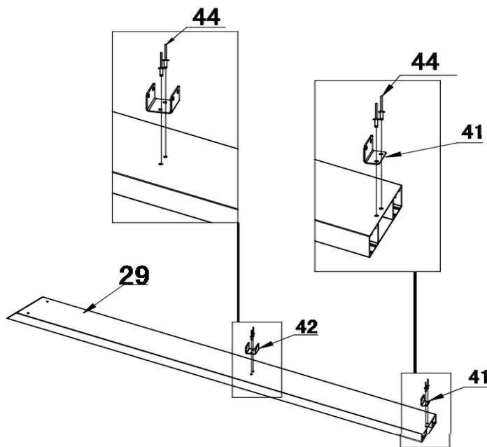
Fixer les équerres de jonctions des bandeaux de toit aluminium
