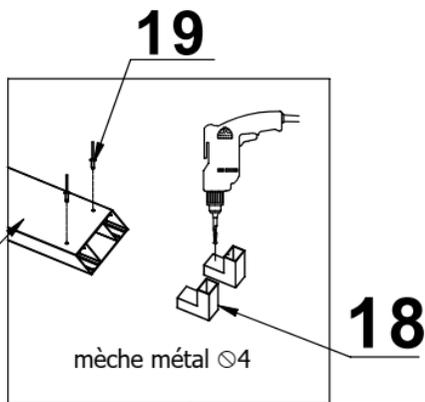
Enclencher les coins de jonction dans les bandeaux de toit. Pré percer les coins dans le bandeau, enclenchés à fond. Fixer les coins à l'aide des rivet, et de la pince à riveter.
