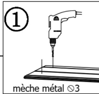
Positionner les lames de toit sur les pannes alu puis pré-percer dans les rainures avant de les fixer
