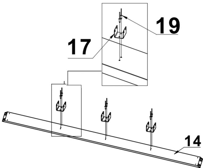
Fixer les accessoires de jonction des bandeaux de toit aluminium.
