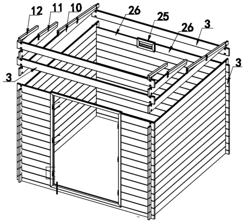
⚠ Assembler les pannes de toit aluminium, en vérifiant le coté gauche /droit (biseau vers l'avant)
