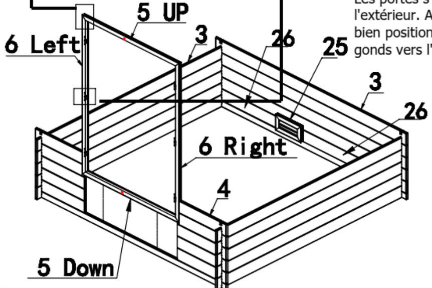
⚠ Les trous pré-perçés dans le cadre de porte (5 Up et 5 Down) doivent être positionnés à gauche (ce sont les trous de blocage de la porte de gauche)
