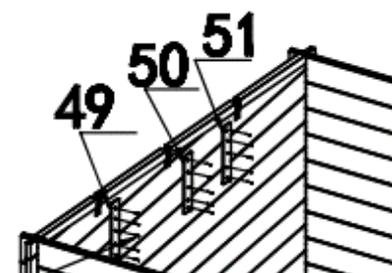
Fixation des pièces de jonction des lames de mur.
