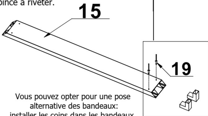
Vous pouvez opter pour une pose alternative des bandeaux: installer les coins dans les bandeaux, et effectuer le perçage puis le rivetage de l'ensemble des pièces une fois placées sur l'abri
