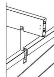
Assembler les pannes de toit aluminium, en vérifiant le coté gauche et droit (biseau vers l'avant)
