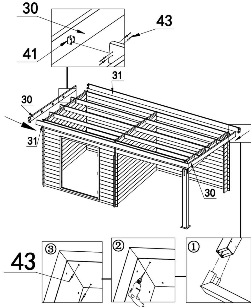
Percer les coins de jonction et de renfort des bandeaux, et les riveter avec la pince à rivets.
