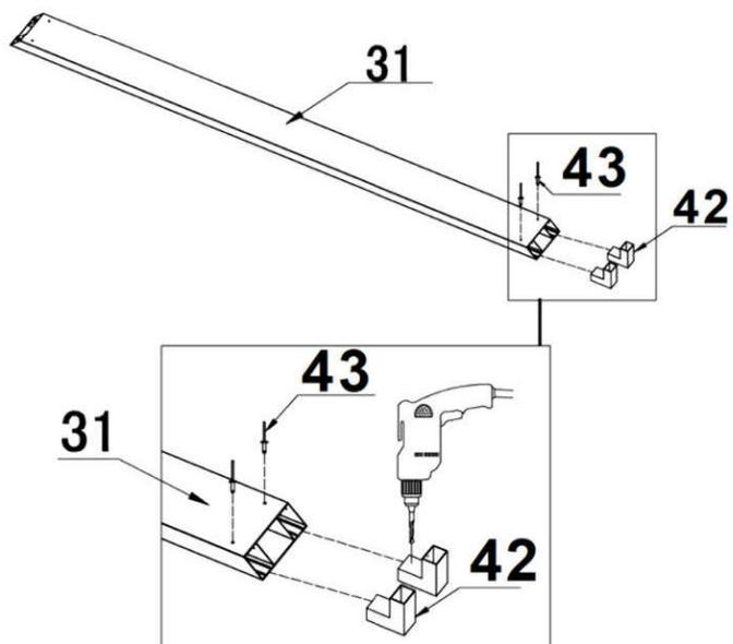
Placer les coin de renfort dans la panne de toit, et percer au bon emplacement.
