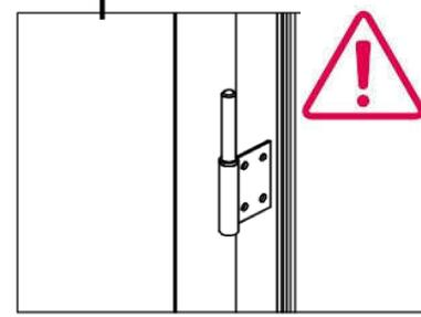
Les portes s'ouvrent vers l'extérieur, attention à bien positionner les gonds vers l'extérieur. Vérifier bien que le profil 18 est positionné en bas du cadre aluminium. La porte de gauche est équipée de loquets de fermeture en haut et en bas, qui viennent dans les trous des profils. Veiller à ce que les profils haut/bas soient bien positionnés avec ces trous du côté gauche.
