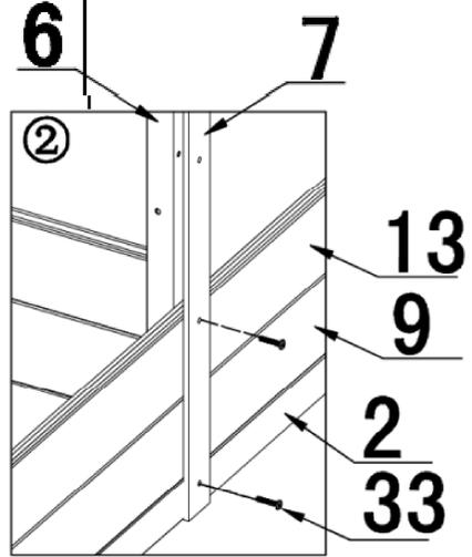
Selon les cas, vous devrez percer les lames de fond composite, pour fixer les pièces 6 et 7, puis insérer les lames 11 et 14. Vérifier le bon équerage de la partie fermée de l'abri.
