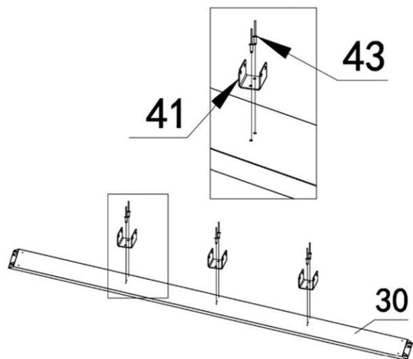
Fixer les équerres de jonctions des bandeaux de toit aluminium
