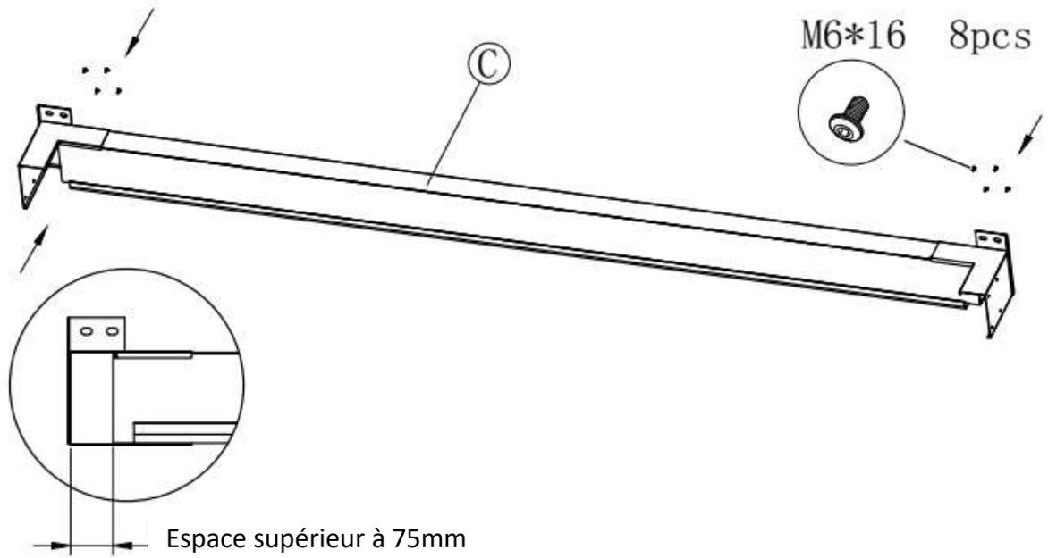
2- Installer la poutre sur le mur :
