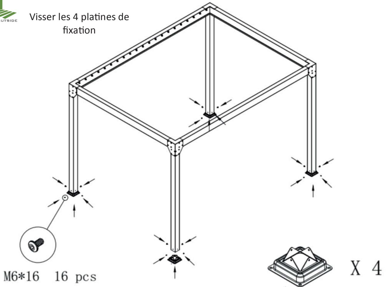
Mesurez les distances (a et b) au niveau supérieur et inférieur des 4 poteaux. Modifiez l'angle des poteaux si nécessaire pour qu'elles soient identiques. Déterminer l'emplacement définitif de votre pergola, et à l'aide d'un marqueur repérez l'emplacement des trous pour positionner les plaques au sol. Fixer au sol à l'aide des chevilles et vis M8x60
