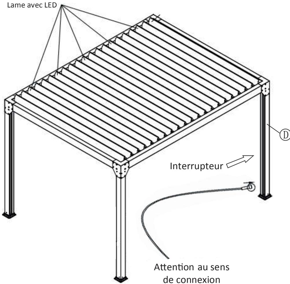
Ajuster la position du fil de connectique LED, de telle manière à ne pas gêner les manoeuvres d'ouverture et fermeture des lames.
