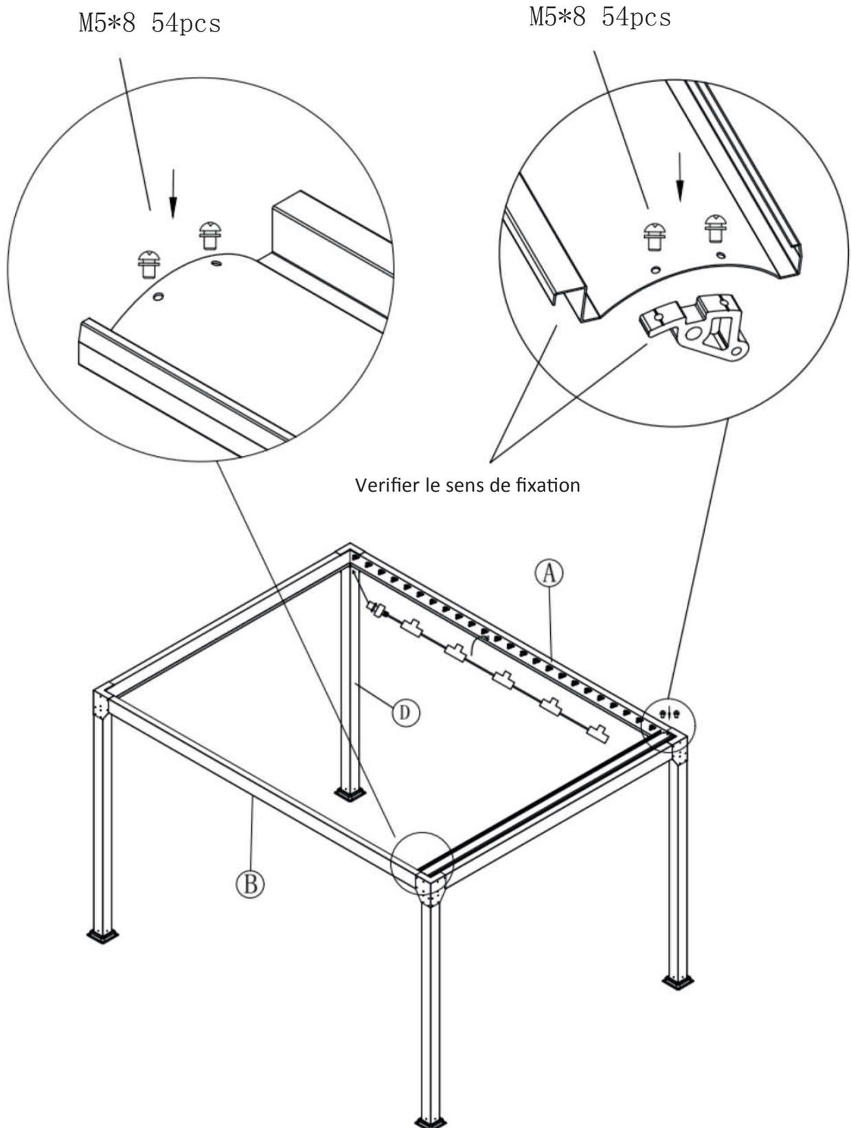
Si l'assemblage est difficile, vous pouvez brancher l'alimentation électrique et inclinez les lames dans la meilleure position pour finaliser votre montage. Vérifier que chaque lame prévue est bien connectée en allumant les LED.
