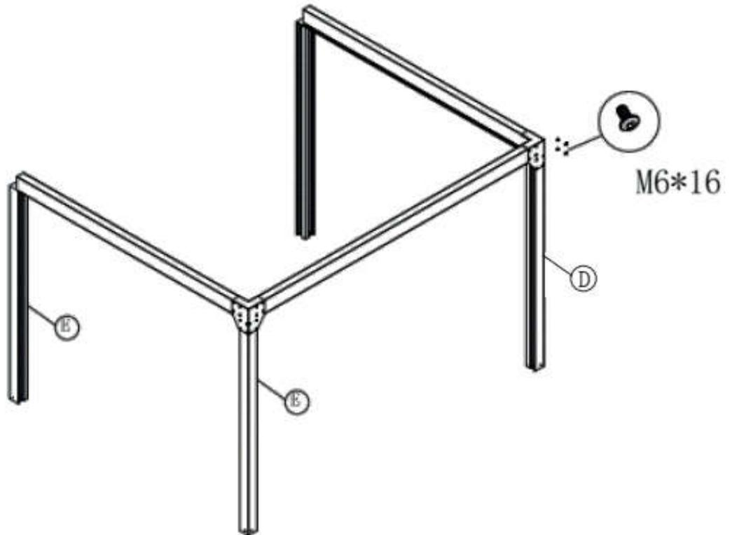
Installez la poutre B sur les 2 poteaux E, et vissez les platines
