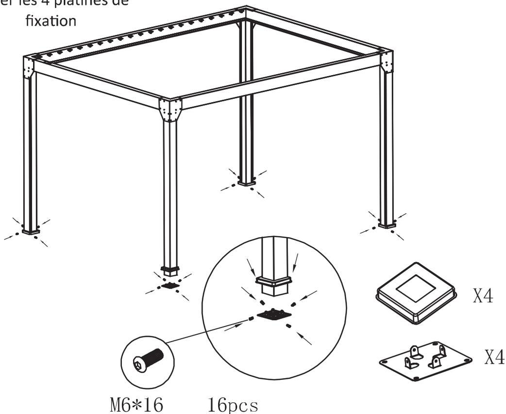
Mesurez les distances (a et b) au niveau supérieur et inférieur des 4 poteaux. Modifiez l'angle des poteaux si nécessaire pour qu'elles soient identiques. Déterminer l'emplacement définitif de votre pergola, et à l'aide d'un marqueur repérez l'emplacement des trous pour positionner les plaques au sol. Fixer au sol à l'aide des chevilles et vis M8x60
