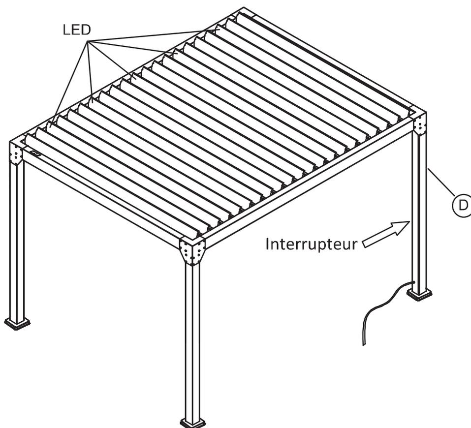
Ajuster la position du fil de connectique LED, de telle manière à ne pas gêner les manoeuvres d'ouverture et fermeture des lames.
