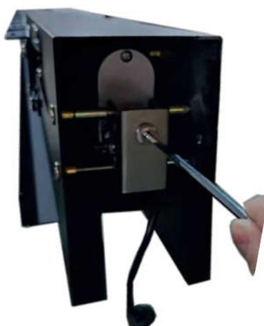
En intervenant sur la vis du moteur, vous allez ajuster le degré de fermeture des lames.
