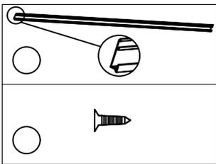
Finaliser en installer la dernière partie du rail, et verrouiller avec les vis (attention à bien positionner les ressorts)
