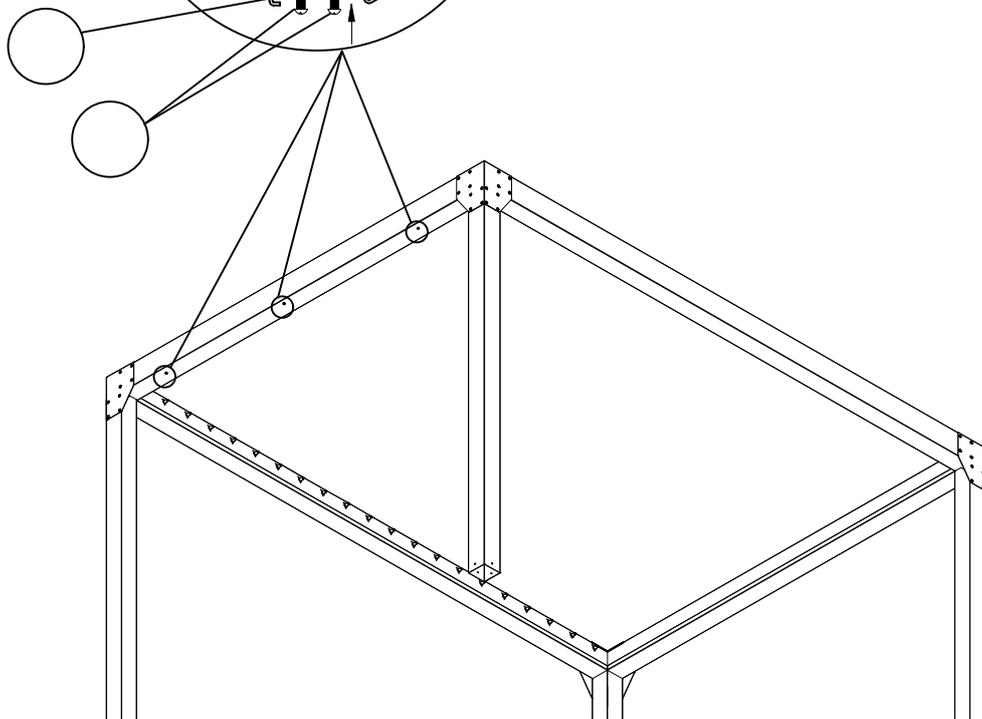
Au sol, dévisser les vis à chaque extrémité du capot, et retirer le du coffre.
