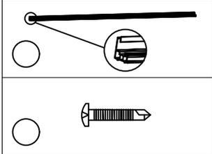
Installer les rail de guidage dans leur emplacement (rainurage) sur chacun des poteaux et visser.
