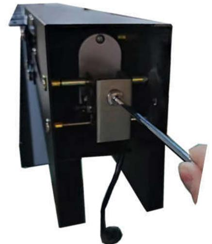
En intervenant sur la vis du moteur, vous allez ajuster le degré de fermeture des lames.
