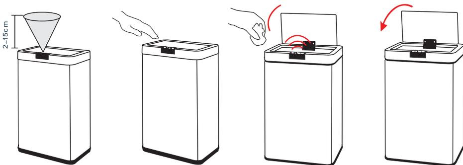
La zone du capteur est au-dessus de 2 à 15 cm au-dessus du panneau de capteurs
