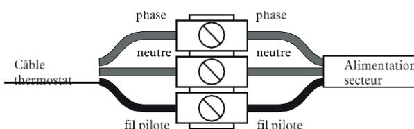
Cas 1 : Système électrique utilisateur **sans fil pilote** : le fil pilote (noir) ne doit pas être raccordé. Si votre installation ne possède pas de fil pilote, ce fil ne doit pas être raccordé. Ne jamais utiliser le fil de terre de votre installation (couleur jaune-vert) pour connecter ce fil pilote. En l'absence de fil pilote, isolez le bout dénudé du fil noir pour éviter tout contact électrique avec les autres fils ou la terre.
