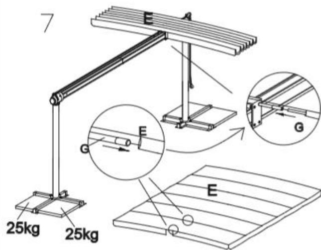
Positionner 2 dalles de blocage minimum, de 25kg minimum, par pied (non inclus).
