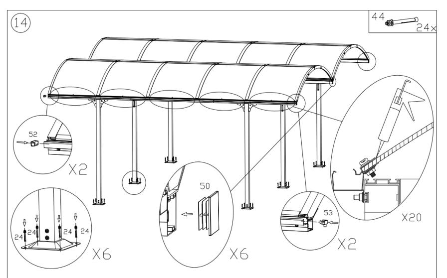
Pour maximiser l'étanchéité des gouttières, appliquer un mastic d'étanchéité d'extérieur (non fourni) à toutes les pièces en contact.
