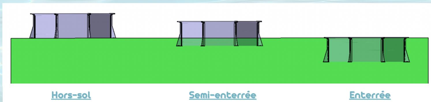
Veillez à ne pas installer votre piscine sur sol récemment remblayé et/ou non stabilisé. Il est nécessaire de décaper votre terrain et de mettre le terrassement de niveau.
