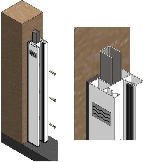
Pour améliorer la performance, un joint silicone (à usage extérieur) peut être appliqué horizontalement et verticalement.
