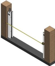
Mesurez la largeur entre les deux murs, en vous positionnant à mi-hauteur des poteaux.
