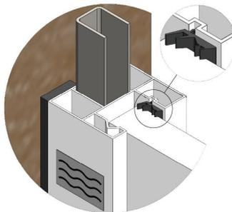
**Attention: le panneau doit recouvrir en totalité les joints à lèvres des poteaux et le joint de seuil doit être bien plaquer au sol. Les joints à lèvres ne doivent pas être étirés ou pliés une fois le panneau mis en place.**
