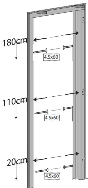
Percer le cadre avec une mèche à bois  $\varnothing$  3mm aux 6 points indiqués.
