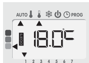
Fil pilote = Éco - 1 Confort - 1°C
