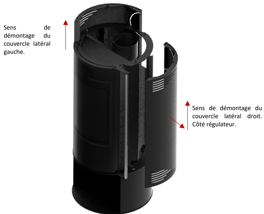
Figure 12 - Démontez les couvercles latéraux de l'équipement
