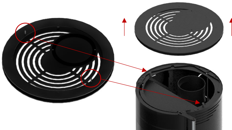
Figure 10 - Démontage du dessus en tôle
