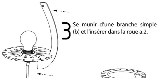
3 Se munir d'une branche simple (b) et l'insérer dans la roue a.2.
