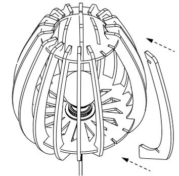
6 Insérer les 5 pales numérotées (d) dans les encoches correspondantes jusqu'à obtention du modèle fini.
