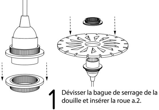
1 Dévisser la bague de serrage de la douille et insérer la roue a.2.
