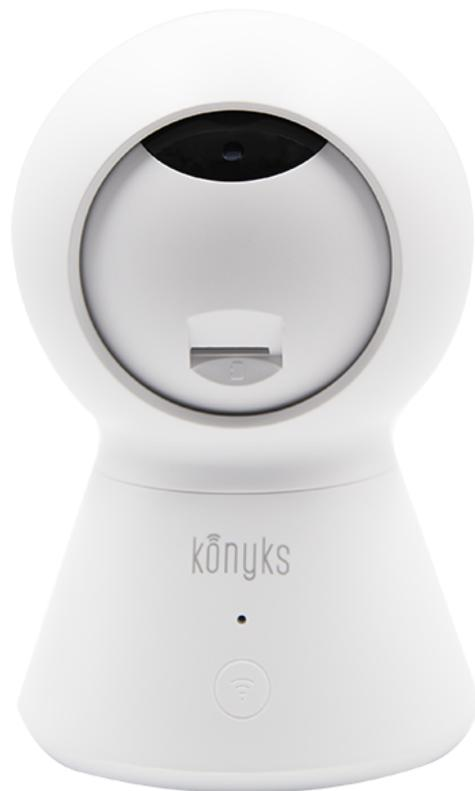
Lorsque la Fonction mode Vie Privée est activée, l'œil de la caméra vient se placer sous le cache
