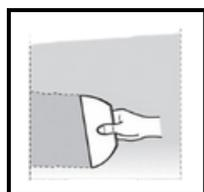
**5.** Appliquer des couches supplémentaires d'enduit si nécessaire.
