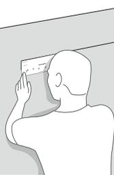
Placez le gabarit sur l'angle gauche, une fois bien positionné pointez les deux trous à l'aide du crayon
