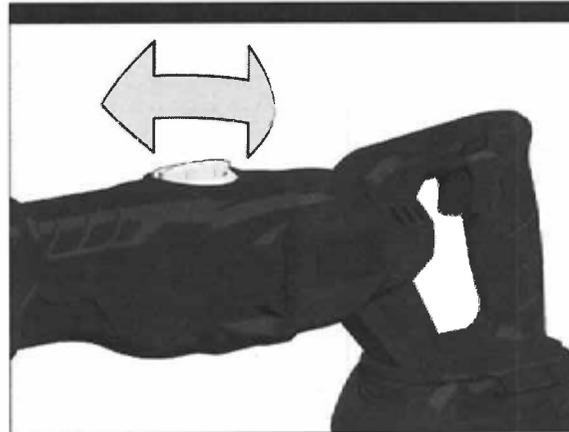
Um Beschädigungen der Maschine zu vermeiden, den Pendelschalter erst nach Stillstand der Maschine betätigen. Die Pendelung nicht beim Sägen in Metall verwenden.
