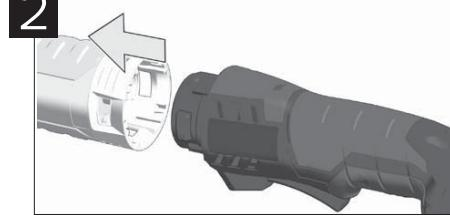
Die Antriebsseinheit darf nur mit montiertem Aufsatzgerät betrieben werden. Es sind 3 Positionen möglich (Aufsatzgerät nur beispielhaft).
