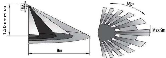
Hauteur d'installation : 1,20m environ      Distance de détection : Max.9 mètres
