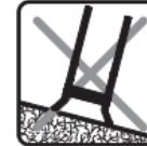
N'utiliser que sur une surface plane, ferme et horizontale
