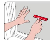
6. Vaporisez la surface du film avec de l'eau et utilisez la raclette pour retirer l'humidité du centre vers les bords.
