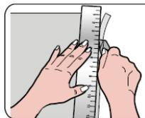
2. Marquez les dimensions souhaitées au dos du film en respectant une distance de 2 mm par rapport au cadre de la fenêtre et découper le film.
