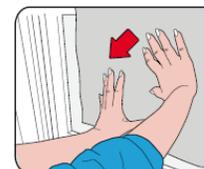
5. Placez le film sur la vitre. Le film glisse et se positionne facilement sur la surface vitrée humide.
