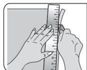
**3 Couper.** Posez le film sur une surface propre et dépourvue de poussière (pas sur un tapis en raison du chargement statique). Coupez le film aux dimensions désirées à l'aide d'une règle et du cutter.
