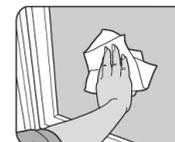
**8 Essuyer les restes d'eau.** Utilisez ensuite un chiffon doux en coton pour retirer toute trace d'eau. Conseil : veillez particulièrement à une pose soignée sur les extérieurs. Les côtés et les angles du film anti-chaueur ne doivent pas être en contact avec le cadre de la fenêtre et les joints en caoutchouc. Dans le cas contraire, cela entraverait l'adhésion du film sur la fenêtre.
