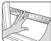
**2 Mesurer.** Mesurez votre fenêtre. L'important est la surface à l'intérieur du cadre de la fenêtre ou à l'intérieur des joints en caoutchouc. Nous recommandons de conserver un intervalle de 2mm entre le film et le cadre de la fenêtre.
