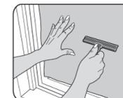
**7 Retirer l'eau avec la raclette.** Retirez maintenant l'humidité entre la fenêtre et le film à l'aide de la raclette fournie, en partant du centre vers l'extérieur.
