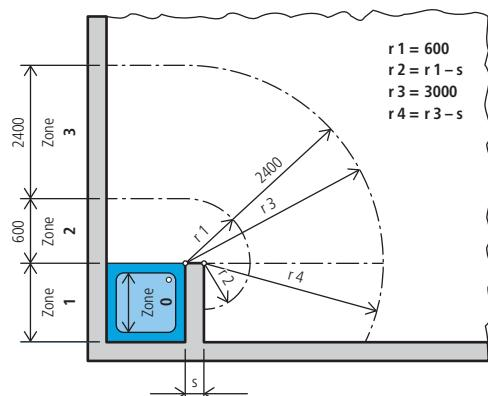
Le chauffe-eau instantané de l'équipement de douche CEI 5.7 kW est conforme à la classe de protection IP 25 et peut donc être installé dans la zone de protection 1 selon VDE 0100, Partie 701.
