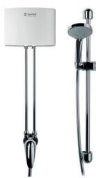
Petit chauffe-eau instantané électronique avec robinet mélangeur pour l'alimentation économique en eau chaude d'une douche entre 35 °C à 45 °C. L'eau est chauffée directement pendant son écoulement, ce qui supprime les pertes thermiques et permet de disposer d'eau chaude à tout moment. La douchette et la tige murale sont fournies avec l'équipement de douche. La douchette spéciale est parfaitement adaptée au débit économique de moins de 4l/min.
