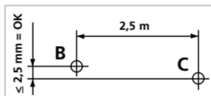
le point C. Vérifiez si la ligne horizontale du point C se trouve à  $\pm 2,5 \text{ mm}$  à la même hauteur que le point B. Répétez l'opération en faisant pivoter vers la gauche.
