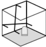
Ne pas dégager le blocage de transport, faire glisser l'interrupteur à coulisse (3) vers la droite. Il est maintenant possible de travailler sur des plans inclinés. Il n'est pas possible d'effectuer un nivellment horizontal ou vertical dans ce mode étant donné que les lignes laser ne s'orientent plus automatiquement. La LED (1) et les lignes laser clignotent en vert.
