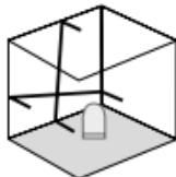
Deactiveer de transportbeveiliging niet en zet de schuifschakelaar (3) naar rechts. Nu kunnen schuine vlakken worden aangelegd. In deze modus kunt u niet horizontaal resp. verticaal nivelleren omdat de laserlijnen niet meer automatisch uitlijnen. De led (1) en de laserlijnen knipperen groen.
