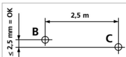
draaien en punt C markeren. Controleer nu of de waterpaslijn van punt C op gelijke hoogte ligt met punt B - met een tolerantie van max.  $\pm 2,5 \text{ mm}$ . Dezelfde controle kunt u tevens naar links uitvoeren.
