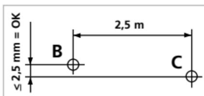
destra e segnare il punto C. Controllare se la linea orizzontale passante per il punto C si trova alla stessa altezza del punto B  $\pm 2,5$  mm. Ripetere la procedura ruotando la croce di collimazione verso sinistra.
