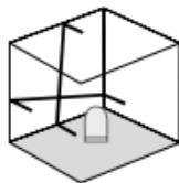
Die Transportsicherung nicht lösen, Schiebeschalter (3) nach rechts schieben. Die Laser mit der AN/AUS-Taste anschalten. Jetzt können schiefe Ebenen angelegt werden. In diesem Modus kann nicht horizontal bzw. vertikal nivelliert werden, da sich die Laserlinien nicht mehr automatisch ausrichten. Die LED (1) und die Laserlinien blinken grün.
