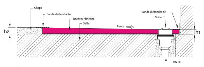
h1 = 39 mm = Receveur de douche (34 mm) + 5 mm de mortier-colle (hauteur de montage côté rigole)
