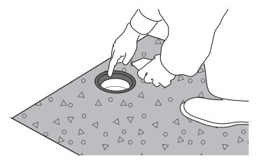
7) Lubrifier le joint du siphon afin de faciliter la mise en place avec le receveur.
