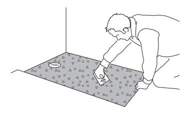
5) Combler la réservation avec un mortier de remplissage, araser au niveau nécessaire en laissant un espace jusqu'à la chape correspondant à l'épaisseur du receveur de douche (50, 60 ou 65 mm) et à celle de la colle (env. 5 mm). La surface doit être plane.
