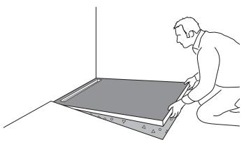
8) Positionner le receveur en plaçant la sortie sous le receveur dans le joint du siphon et l'insérer en appuyant fermement sur le dessus du receveur. Puisque le receveur est monopente, il y a un dénivelé entre le niveau de la chape et le bord du receveur.
