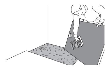
6) Retirer le couvercle de protection. Encoller entièrement la sous-face du receveur avec une colle à carrelage flexible (type C2) en une couche régulière, et une épaisseur suffisante afin de régler le niveau final.
