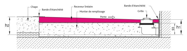
$h_1 = 137 \text{ mm}$  (hauteur de montage totale minimale côté rigole)
