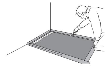
10) Mettre en place la grille inoxydable. Votre receveur Qboard® liquid line est prêt à être carrelé.
