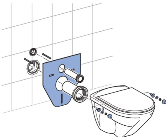
Fixation d'un WC suspendu avec kit d'isolation phonique préalablement découpé à la géométrie de la face arrière de la cuvette
