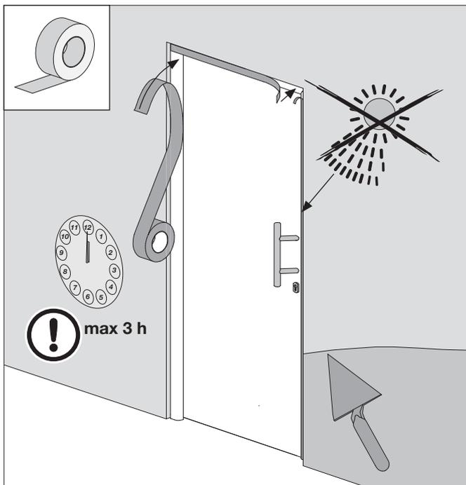
**DE** Bei der Verwendung von Abdeckklebebändern beim Einbau / Einputzen / Malern, dürfen nur schwach klebende Klebebänder verwendet werden
