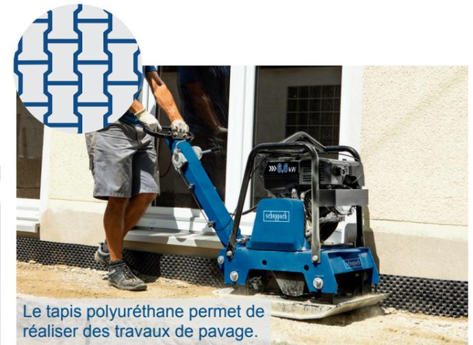
Le tapis polyuréthane permet de réaliser des travaux de pavage.
