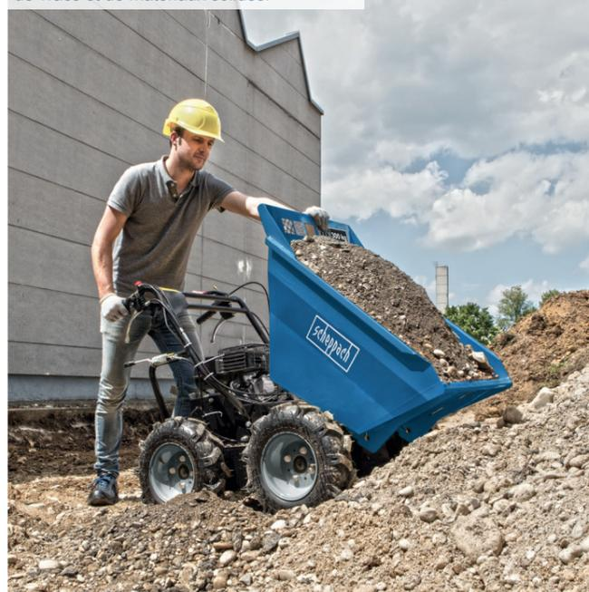
Les endroits difficiles d'accès peuvent être facilement atteints grâce à sa faible largeur de passage de 760 mm.
