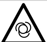
Advarsel! Produktet er udstyret med en automatiseret startstyring. Hold fremmede på afstand, når produktet er i brug!
