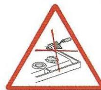
Le contact direct de plâtre ou de colle pour plaques ou carreaux de plâtre avec la sous-face du receveur est à proscrire. Il ne doit pas y avoir de blocage vertical ni latéral du receveur.
