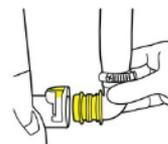
**Compatible avec le préfiltre robuste** optionnel
