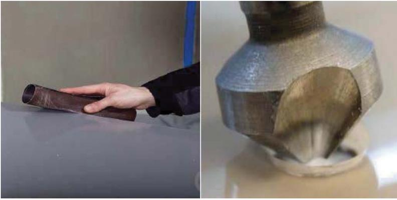
**3.6** Tous les bords, décrochements et perçages doivent être ébavurés ou poncés. Pour l'ébavurage veuillez prendre le papier émeri p120 fourni dans l'emballage.
