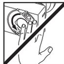
Risque de blessure par les tranchants de la lame réversible. Faites attention à la tête de fraiseage tournante ! Tenez compte du fait que le moteur et donc la tête de fraiseage de votre fraiseuse à bois continuent de tourner après l'arrêt !
