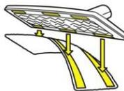
Système de fixation par scratch
