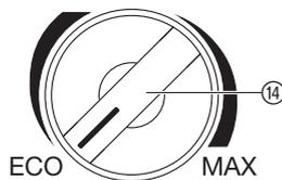
Afin d'économiser l'énergie (jusqu'à 15 %), et en fonction de l'utilisation du moment, il est possible de régler en continu la pression de coupure de la pompe entre **ECO** et **MAX** (la différence de pression entre **ECO** et **MAX** est d'environ 1 bar).
