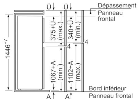
Les dimensions indiquées pour la porte du meuble sont valables pour un joint de porte de 4 mm. En cas d'utilisation d'une autre largeur de joint (max. 14 mm) les dimensions doivent être adaptées.
