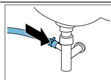
Écoulement dans un lavabo.
