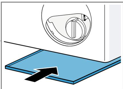
6. Pour permettre au liquide de lavage de s'écouler dans le réservoir, dévissez soigneusement le couvercle de la pompe.
