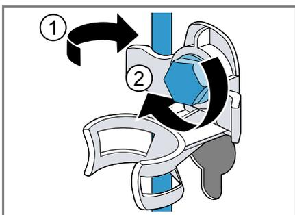
5. Insérez le tuyau dans le support.
